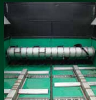
Dosier- und Auflösewalze mit austauschbaren Werkzeugen in Edelstahlausführung
