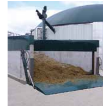
Befahrbarer Feststoffdosierer in Betonbauweise Baureihe ZBC mit hydraulischer Verschlussrampe
