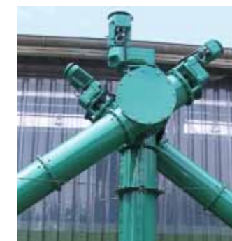
Vertikalspiralförderweg mit 2 alternativen Fermenter- eintragsförderwegen
