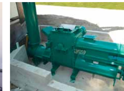
Zerkleinerungstechnik in den Förderweg integriert
