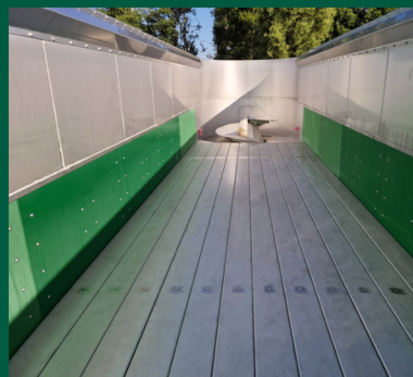
Diseño de las superficies en contacto con el sustrato en acero inoxidable o con revestimiento de plástico.
