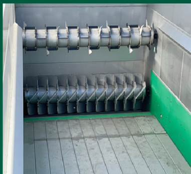
Alternativa: Disolución mediante rodillos con herramientas en lugar de una estrella mezcladora.
