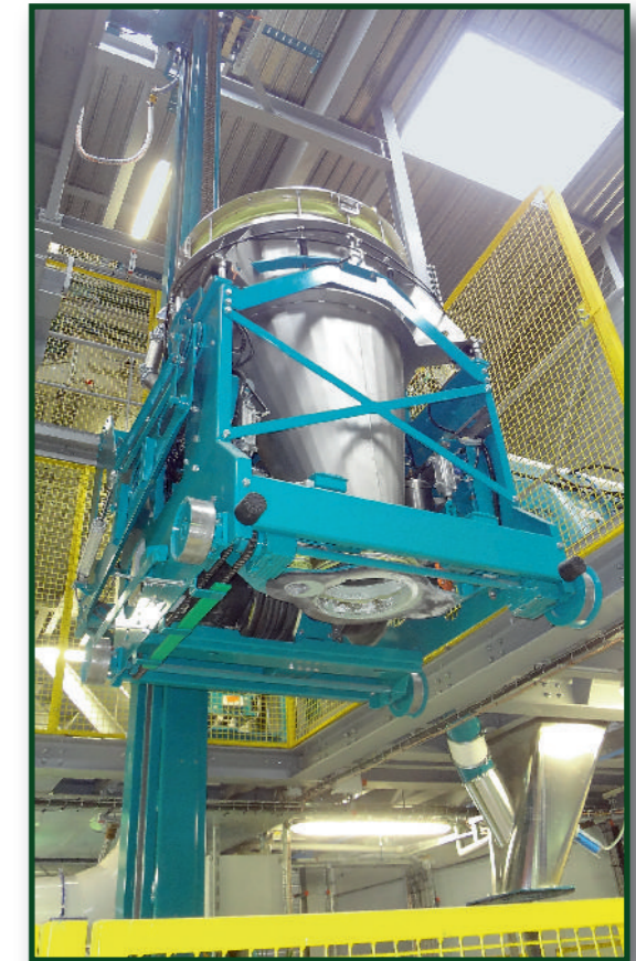
Quicklift mit Hubsäule und festem Behälter
