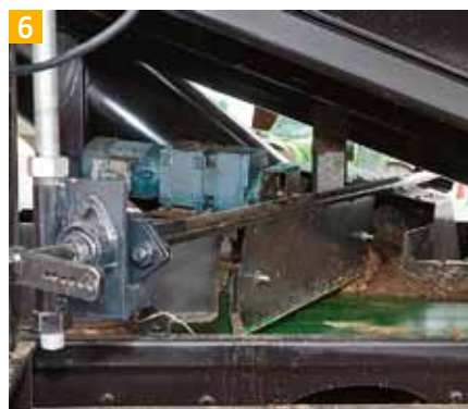
6 Das pendelnd aufgehängte Schild lässt Steine durch, leichtere Rüben aber nicht. Ein Paddel schiebt das vom Schild aufgefangene Material zur Öffnung einer Förderschnecke.
