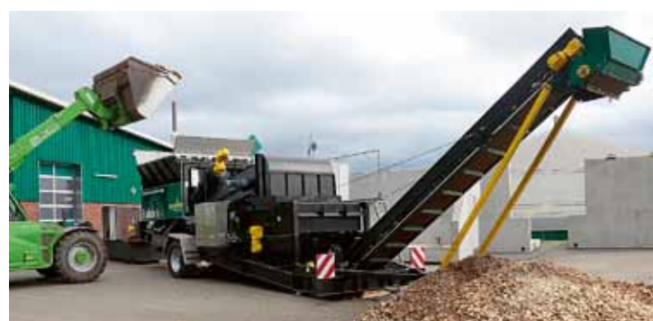
Die 13,50 m lange und 8 t schwere Maschine hat eine Straßenzulassung und lässt sich auf seiner einen Achse transportieren und umsetzen.
