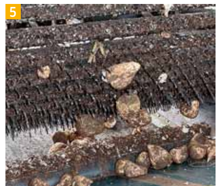
5 Nicht aufgespießte Steine und Rüben werden über das Band unter der Maschine nach hinten transportiert.
