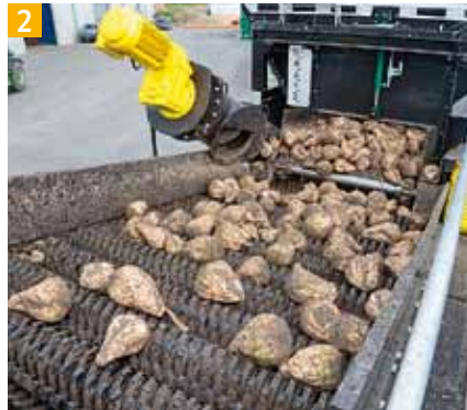
2 Die Schieberöffnung ist hydraulisch verstellbar. Die Siebsterne reinigen die Rüben vor.
