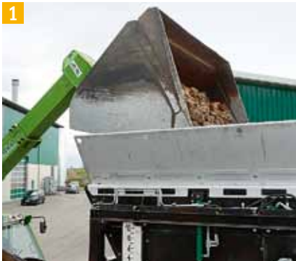
1 Der Teleskopklader füllt Rüben in den 4 m 3 großen Vorratsbunker der Trockenentsteinung.
