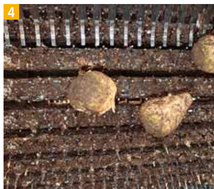
4 Die aufgespießten Rüben drehen mit der Trenntrommel einmal die Runde und werden dann an einem Kamm abgestreift.
