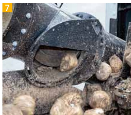
7 Die Förderschnecke holt wie bei der Überkehr eines Mähdeschers die Rüben von unten wieder nach oben auf das Reinigungsband.
